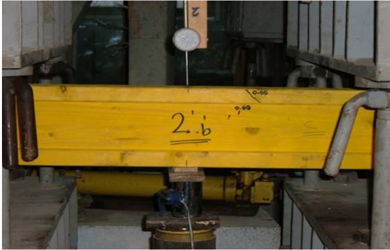
اختبار تحميل كمره خشبية
