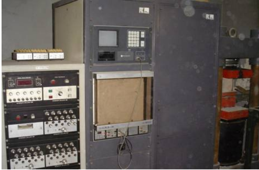
ماكينة إختبار إلكترونية لإجراء الاختبارات عن طريق التحكم في الازاحة
