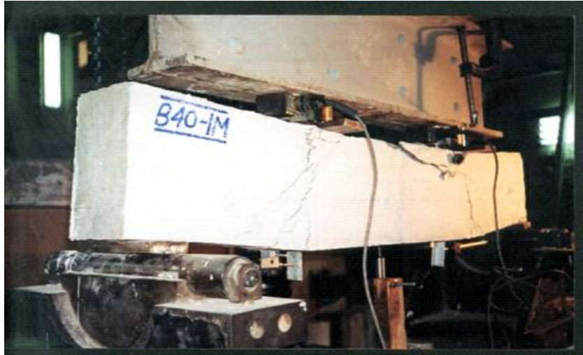
كمرة خرسانية أثناء الاختبار
