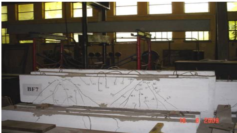
كمرة خرسانية بعد الاختبار
